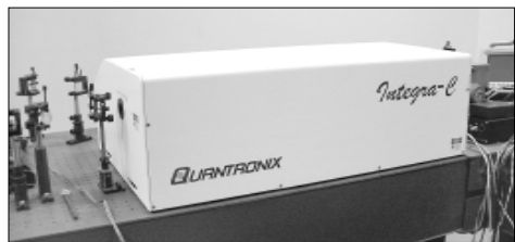
Iš projekto lėšų Fizikos institute įsigytas femtosekundinis lazeris „Integra C“
